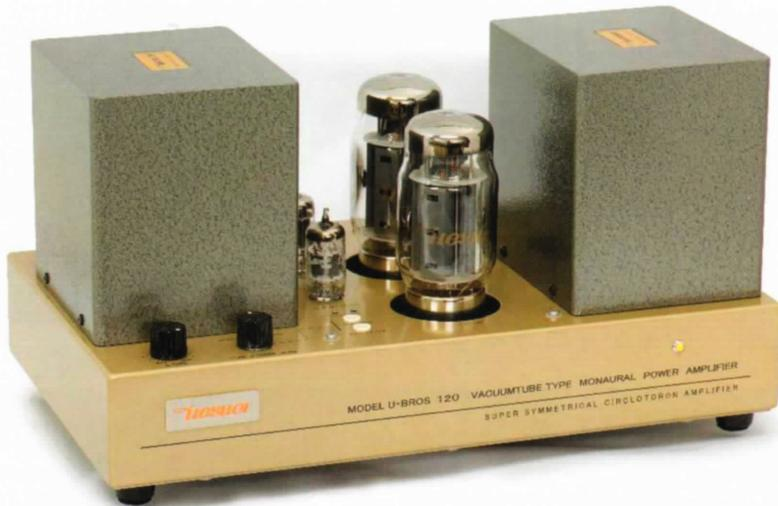
シングル出力段真空管アンプの持つ優れた低レベル再生能力とスピーカー駆動能力の高いハイパワー出力の両立を目指したアンプの開発は永遠のテーマといえます。本機で採用した Circuitron (サークロトロン) 回路では、プッシュプルを構成する出力管に独立フローティング電源から電源が供給される事により、1 次巻線は単巻線で直流電流の流れないシングル出力段の出力トランスと同じ動作を行うことが可能です。この回路ではトランスによるプッシュプル波形の合成を必要としない動作原理を大きな特徴としております。
